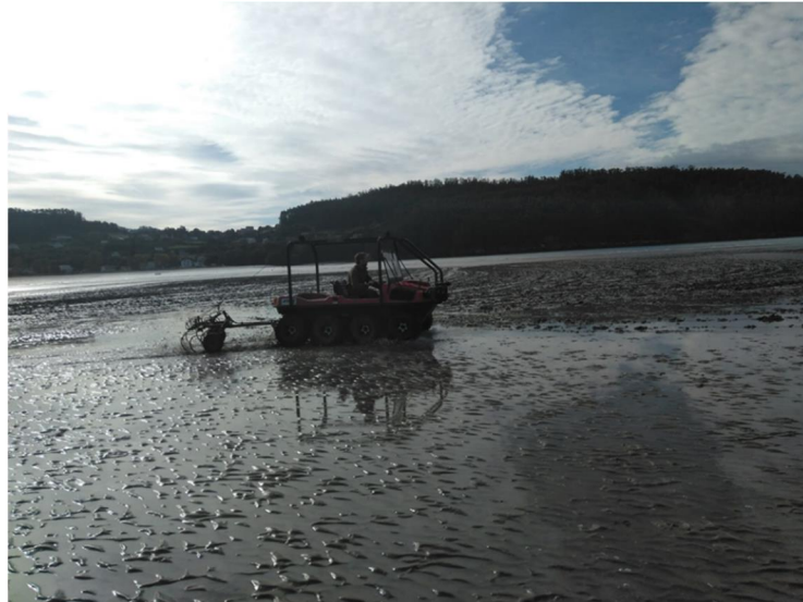
Remoción do sustrato mediante labrado con vehículo anfíbio dotado con grade
